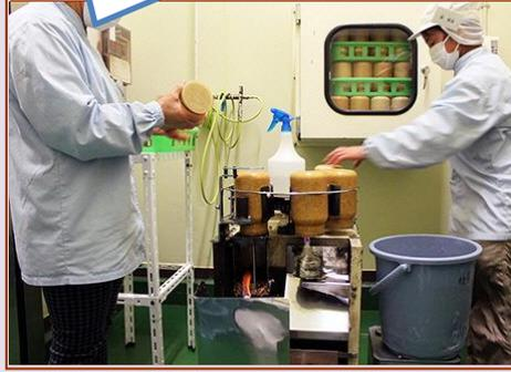
接種作業：接種機のローラーに、培地の入ったビンのコンテナを乗せます。
