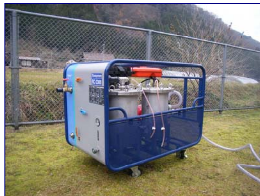
図 5.9 非常用浄水装置
